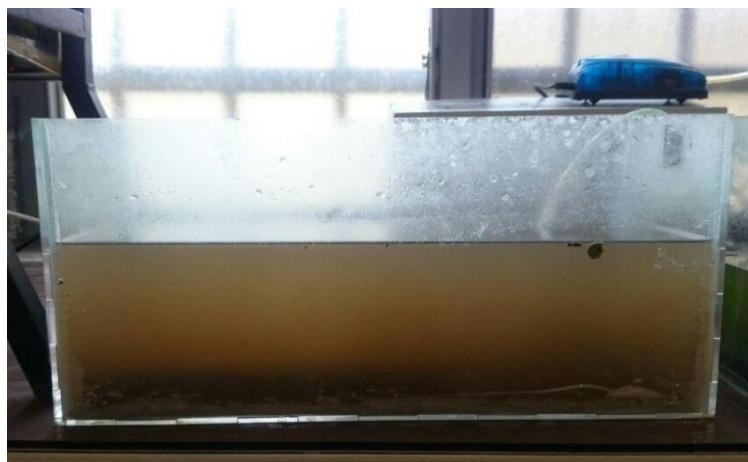
شکل ۳-۱ نمایی از راکتور ناپیوسته متواالی در مقیاس آزمایشگاهی
