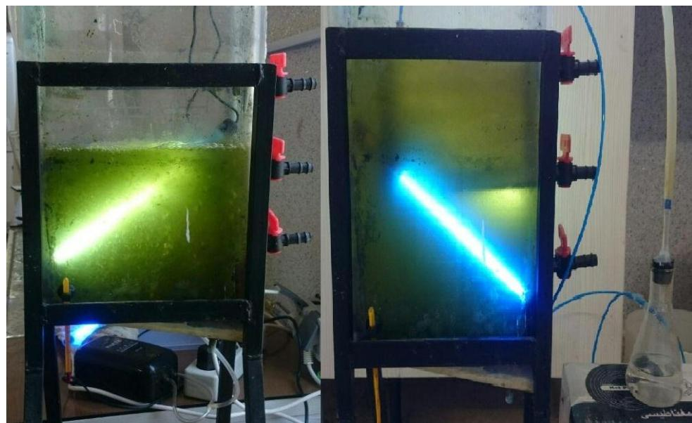
شکل ۸-۳ نمایی از فتوبیوراکتور غشایی در تصفیه شیرابه زباله
